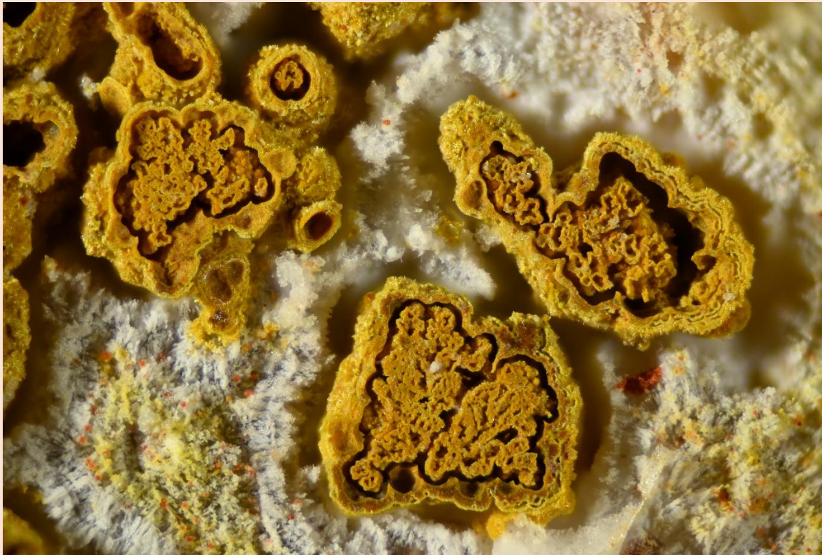
Abb. 5: Ein poliertes Achatfragment mit eingeschlossenen kleinen „Blumenkohlen“ wurde mit verdünnter Flusssäure behandelt. Das \text{SiO}_2 wurde dabei deutlich angegriffen.
